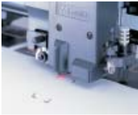
Durch den fest eingebauten Pointer wird das Positionieren der Kopfeinheit zum Kinderspiel
